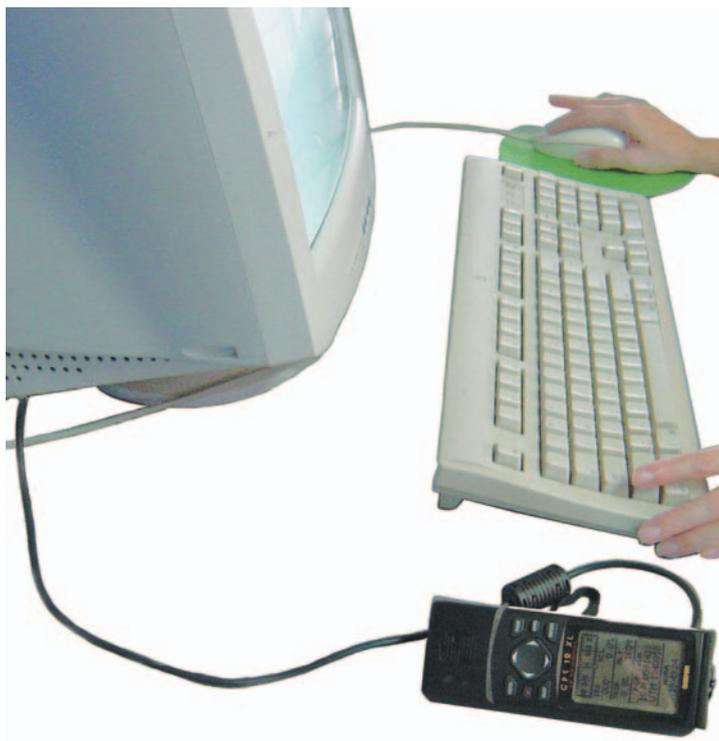
Es más seguro descargar los datos con un cable que conecta directamente el GPS a la computadora, algo que FUGAWI hace perfectamente.
