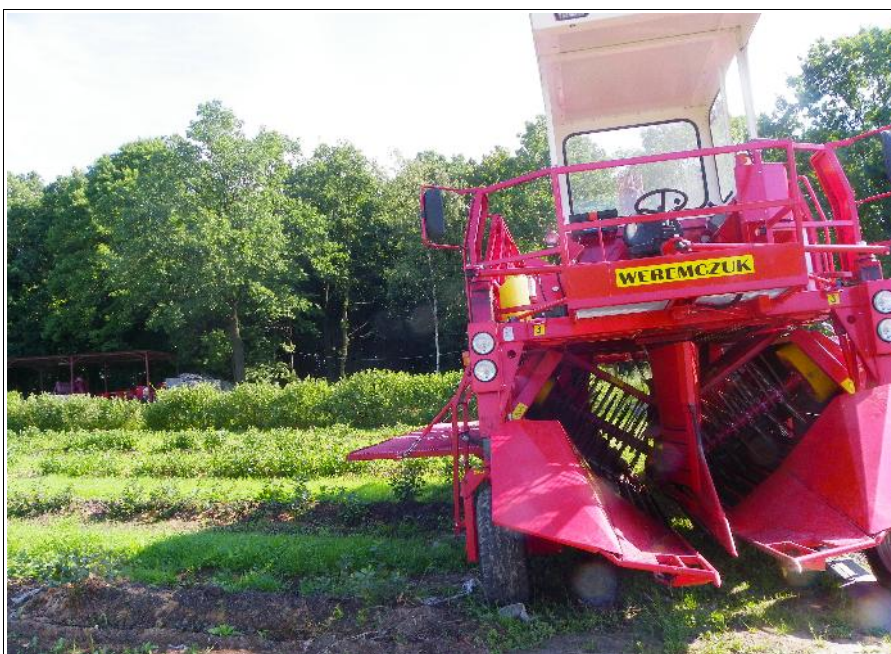
Récolteuse de baies mécanique.
